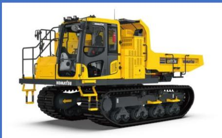
写真は、小松製作所製CD110R-3 全旋回式
