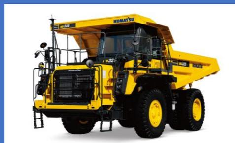
写真は、小松製作所製HD325-8 リジッドフレーム式
