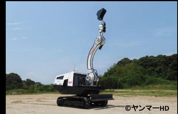
力制御技術を搭載した次世代作業機プロトタイプ
