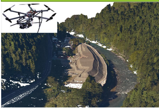
3次元起工測量
