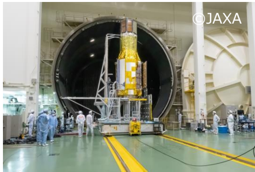
X線分光撮像衛星(XRISM) スペースチャンバ搬入時の様子
