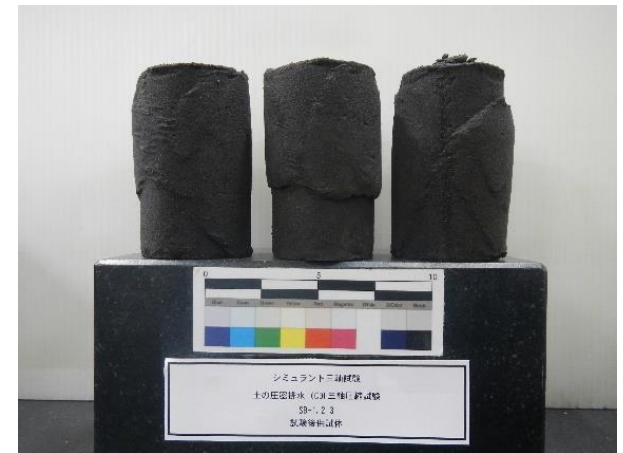
試験後の試験体
