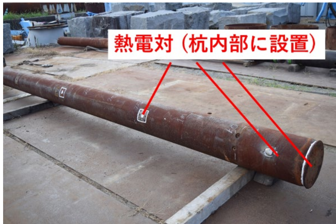
閉端杭 (外径318.5mm)
