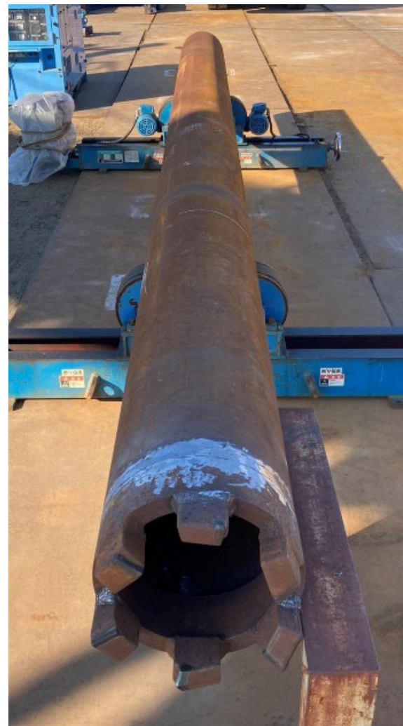
開端杭 (外径318.5mm)
