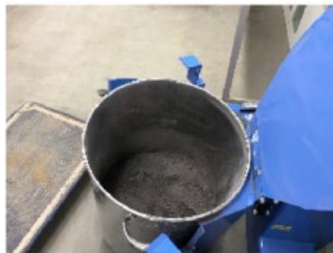
(1) 数%以下の含水率の月シミュラントを土槽に詰める
