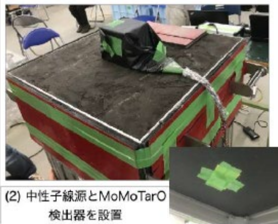
(1) 数%以下の含水率の月シミュラントを土槽に詰める
