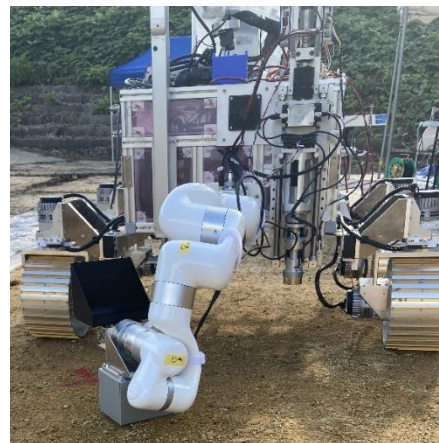
図-2 小型散乱型 RI 密度計の ロボットアームへの取付状況
