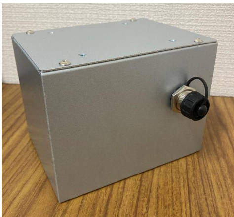
図-1 小型散乱型 RI 密度計
