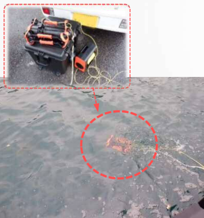
港湾・漁港施設の水中ドローンによる点検状況（試行）
