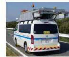
3次元レーザセンサ を用いた舗装損傷検知
