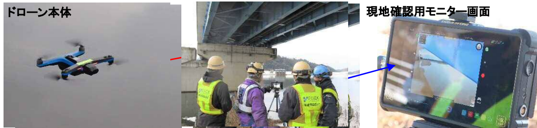
全方向衝突回避センサーを有する小型ドローン技術による点検状況
