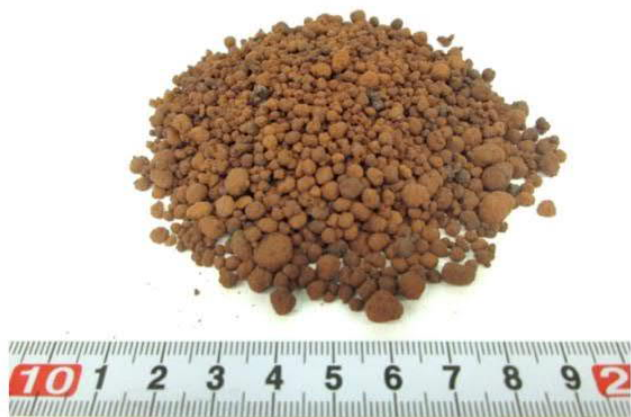
写真1 月の模擬砂から製造された多孔体
