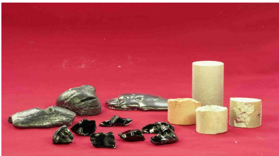
左：マイクロ波利用作製材料 右：コールドプレス法利用作製材料
