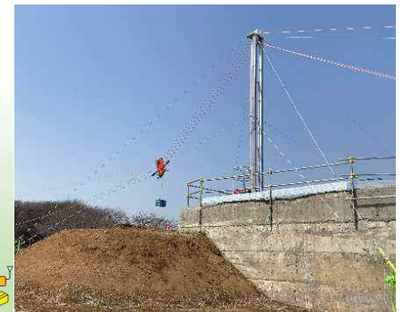
簡易支柱を用いた索道運搬試験
