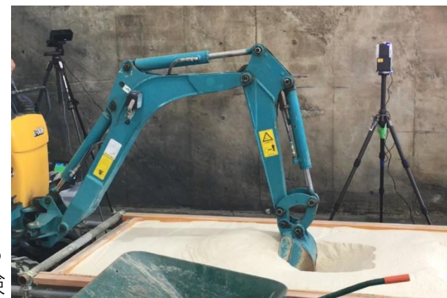
ミニバックホウによる掘削実験
