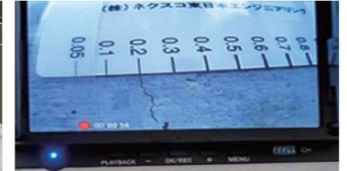
橋脚壁面(ひびわれ幅0.2mm程度)のスキニング画像
