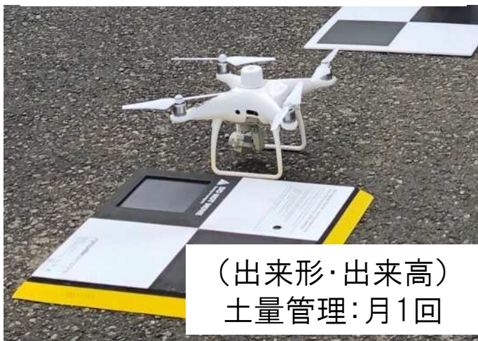
RTK-GNSS付 UAV⇒協力会社
