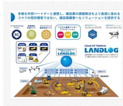
建設現場のデータをICT（情報通信技術）建機やドローンなどで集めた情報を集めるデジタルサービス基盤。同社の建機遠隔監視システム「コムトラック」を搭載する建機は国内で約17万台で、これらの稼働時間や位置データなどを活用する。2017年にコマツがNTTドコモや独SAP、オプティムと共同で立ち上げた会社「ランドログ」で運営する。
