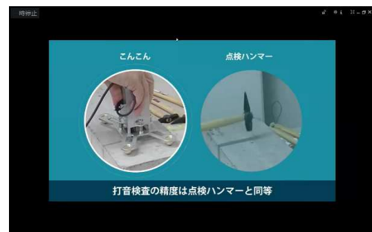
最新ロボット技術の紹介(打音検査ロボット)
